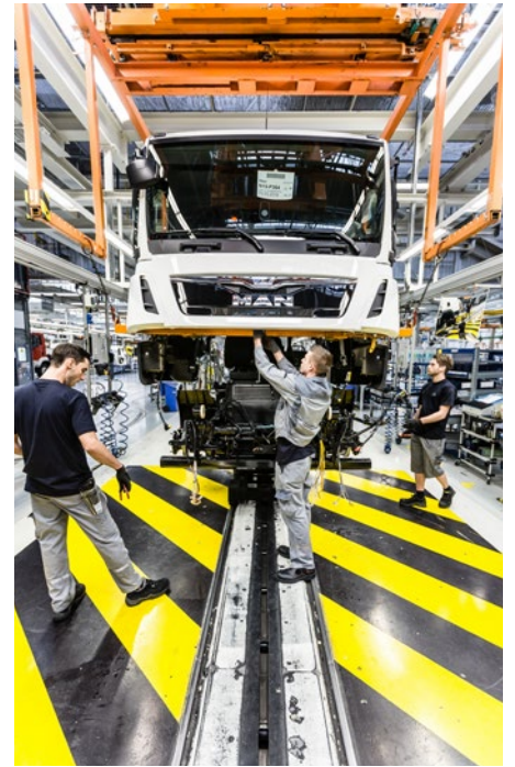
DANIEL SCHNABLEHNER bessert die „Fehler“ der Schweißroboter aus. „Hochzeit“ – das Chassis wird mit dem Fahrerhaus vereint (Foto rechts).
